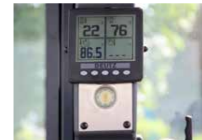
Ny informationsdisplay på b-søjlen for udstødningssystemet.
